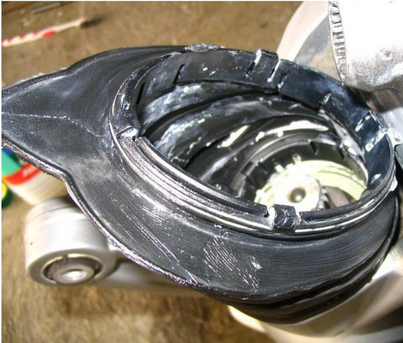
**Soufflet nettoyé et graissé équipé de sa bague de clipsage**
