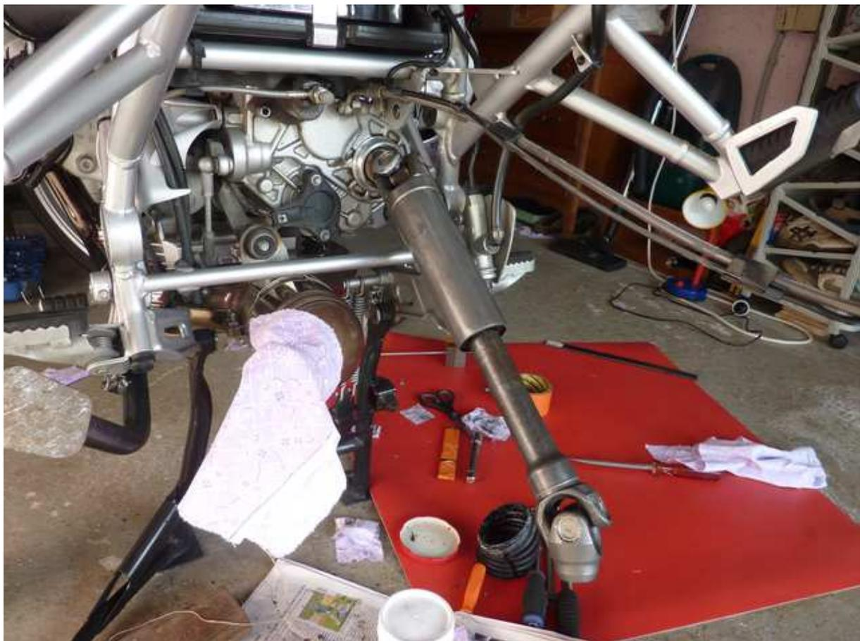
Les roulements de paralever sont à réglage conique : il est normal qu'ils présentent un jeu important une fois que les paliers sont enlevés ! (en poussant le roulement il n'y a plus de jeu).
